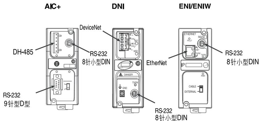
注意: AIC+ 作为隔离模块, 当控制器和操作员界面采用不同电源供电时建议使用。
