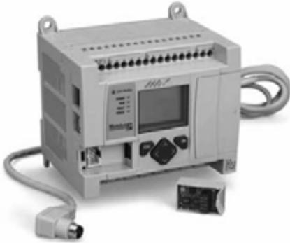
每个 MicroLogix 1100 控制器包含 2 个内置模拟量输入、10 个数字量输入和 6 个数字量输出。使用和 MicroLogix 1200 控制器相同的扩展 I/O 模块，MicroLogix 1100 控制器可以增强其 I/O 控制能力。一个 MicroLogix 1100 控制器可以扩展多达 4 个 1762 I/O 模块。
