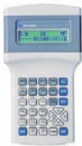
使用 1761-HHP-B30, 可以创建、编辑、监视和排查指令表(Boolean), 并对 MicroLogix 1000 控制器编程, 通过使用外部可移动存储设备可以存储和传递程序。
