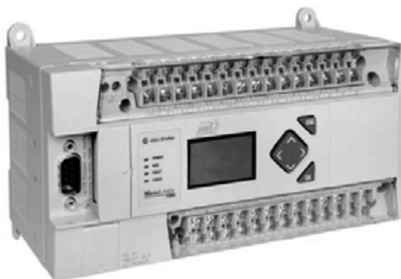
MicroLogix 1400 控制器是 MicroLogix 家族的新成员，MicroLogix 家族中的 MicroLogix 1000、MicroLogix 1100、MicroLogix 1200 和 MicroLogix 1500 控制器都是深受欢迎的产品。MicroLogix 1400 控制器为扩大应用范围而设计，内置模拟量输入，以太网通讯端口、超高速计数器 (HSC) 和脉冲序列输出 (PTO)，MicroLogix 1400 和 MicroLogix 1100 控制器具有相同的重要特性，可以扩展更多 I/O 模块、快速 HSC/PTO 和额外的串口。MicroLogix 1400 弥补了低端控制器在某些场合的应用，这些场合需要的数字量 I/O 点数多达 144 点。
