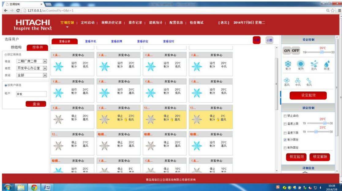
**3.2.4 锁定解除** 如需进行锁定解除, 首先选中需要解除锁定的空调, 点击<锁定解除>按钮, 所有锁定项将全部解除。
