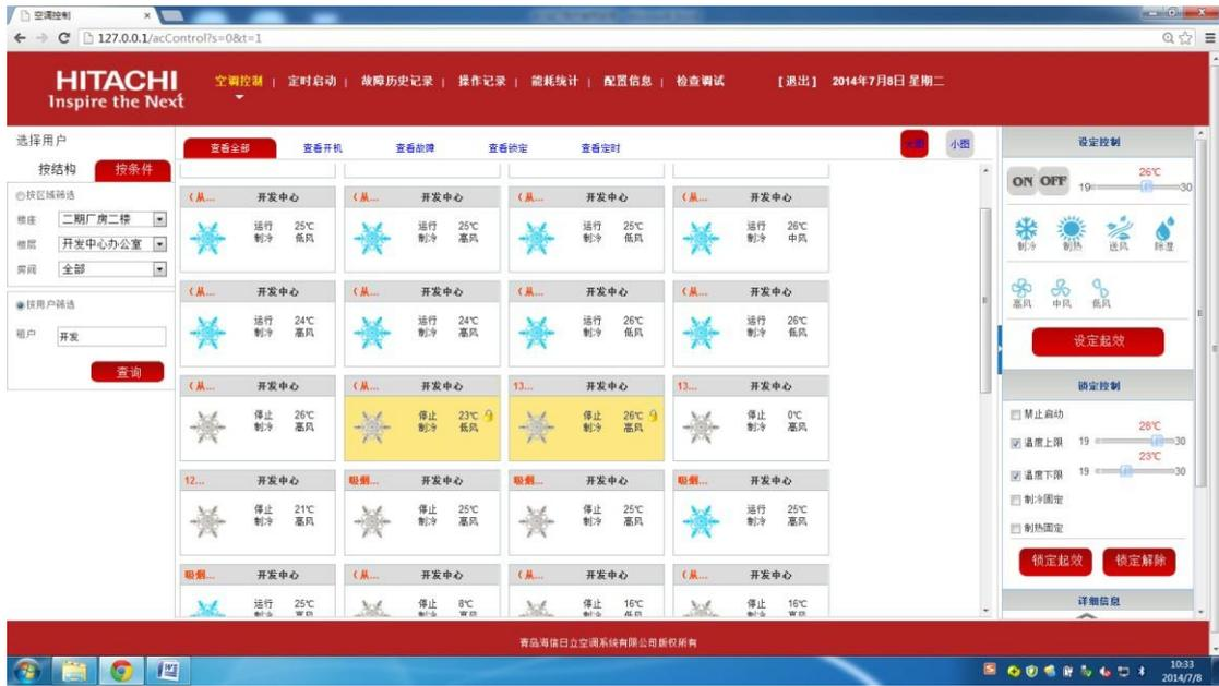
**3.2.3 制冷或制热固定** 首先选择需要控制的空调, 然后在右侧<锁定控制>栏中, 选择<制冷固定>或<制热固定>, 点击<锁定起效>按钮, 设置成功后, 在空调图标设定模式处会有锁定标识。如下图所示：
