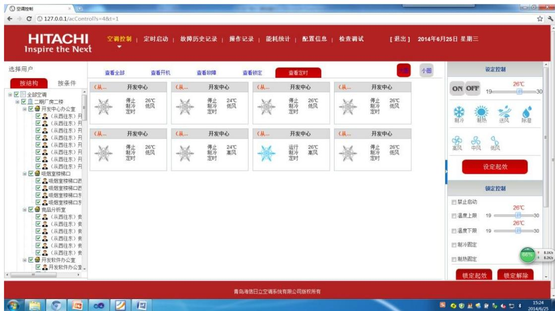
2.4.6 大图 点击<大图>按钮，空调信息以大图形式显示，此时监控界面显示的
